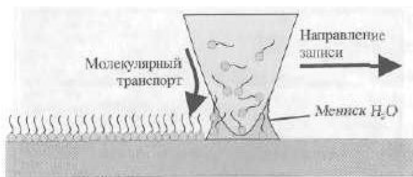
Рис.2. - Схема проведения зондовой нанолитографии с помощью «погруженного пера»
